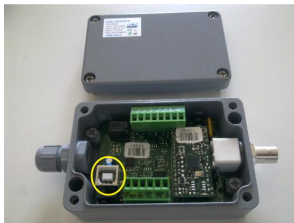
Retirez le capot, et repérez la fiche USB-B femelle (entourée en jaune)
